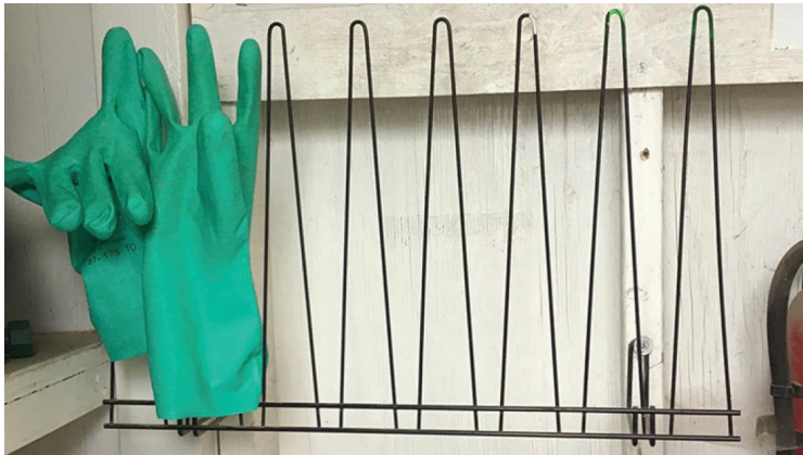
Use un perchero industrial para secar guantes no desechables después de descontaminarlos.
